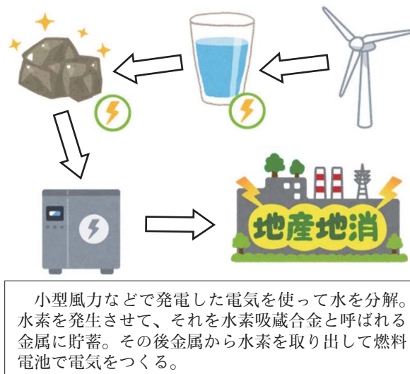
図表6 風力発電で水素を製造する実証実験イメージ
