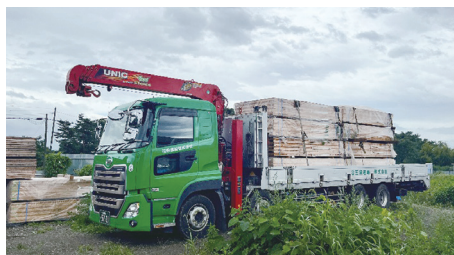
写真3 軽いため積載可能枚数が増えるほか、バックホウでも取扱いが可能に
