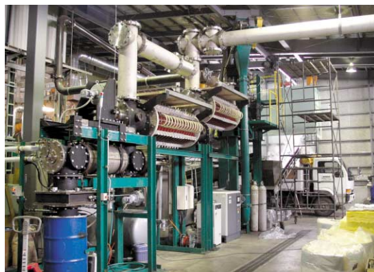
当社開発のリサイクルシステム （電磁誘導加熱炭化・油化装置）
