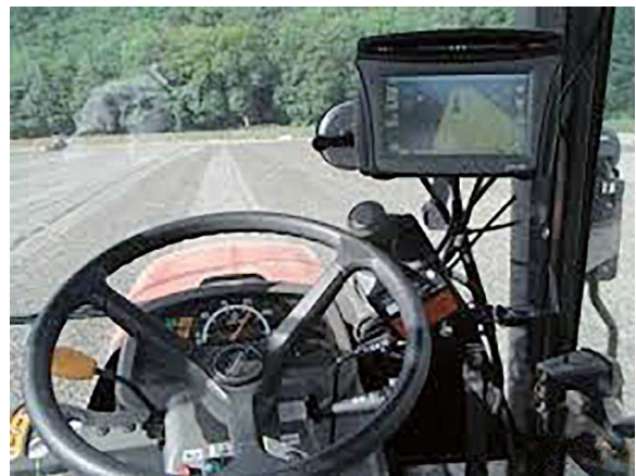
GPSガイダンスシステム（右上がモニター）を搭載したトラクター
