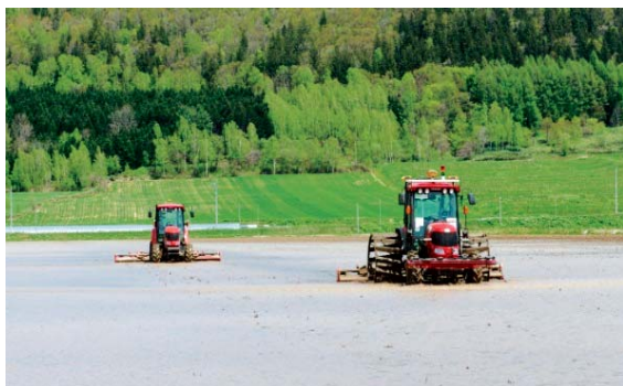
写真3 衛星データを使って無人運行するトラクター
