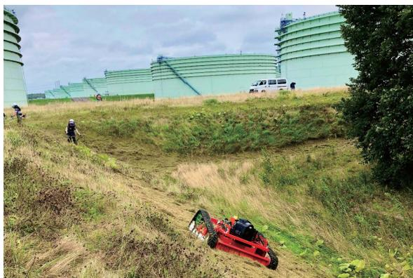
(写真6) 急傾斜地で作業するラジコン芝刈機
