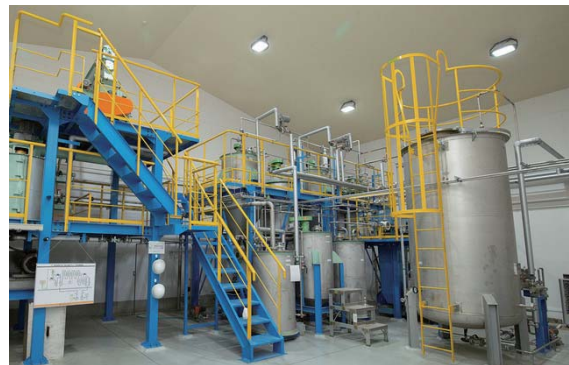
写真 農産品加工施設としての活用事例(士別市内) (旧武徳小学校体育館内に設置された菜種油の搾油プラント)
