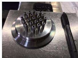
①充填機械用多点ノズル
