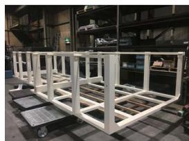
③半導体製造装置用フレーム
