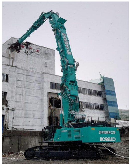
写真：超ロング高所専用機（35m）「SK1300DLC」
